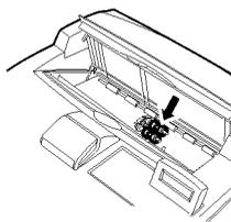
Откройте крышку А и после извлечения барабана/картриджа с тонером очистите валик подачи.
