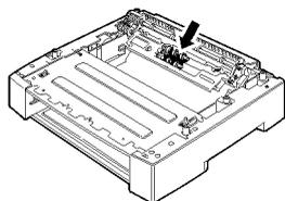
Даже без установки блока лотка можно очистить валик подачи, выдвинув лоток для бумаги.
