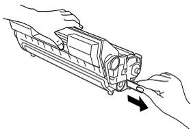
**4.** Поместите барабан или картридж с тонером на плоскую поверхность и извлеките изоляционную ленту в горизонтальном направлении.
