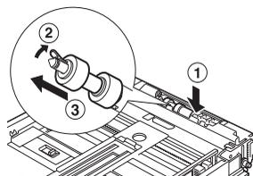
3. Протрите детали принтера слегка влажной мягкой тканью.
