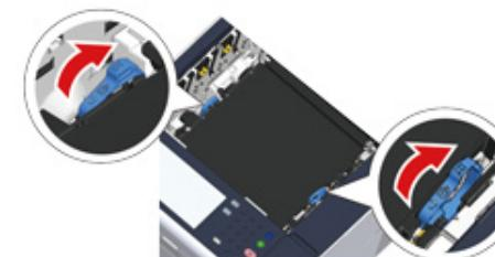
**12** Uchopte fixační jednotku za držadlo a vložte ji do tiskárny.
