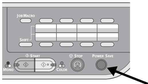
Quando a unidade não é usada por 30 minutos (o padrão de fábrica), ela automaticamente entra em modo de economia de energia para reduzir o consumo de energia.
