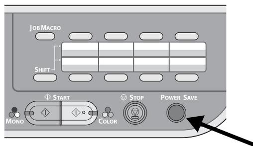
Quand votre appareil reste inutilisé plus de 30 minutes (durée par défaut définie en usine), il se met automatiquement en mode d'économie d'énergie afin de réduire sa consommation énergétique.
