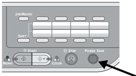
Si no utiliza su equipo durante 30 minutos (el valor predeterminado de fábrica), el equipo automáticamente se ajusta en el modo de ahorro de energía para reducir el consumo de energía.
