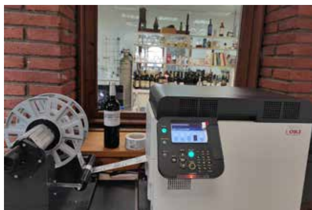
Impressora de etiquetas de 5 cores OKI Pro1050 a imprimir rótulos de vinho
