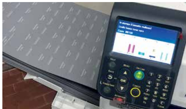
Stan 5 tonerów (CMYK + biały) na panelu z wyświetlaczem drukarki Pro9542 firmy OKI
