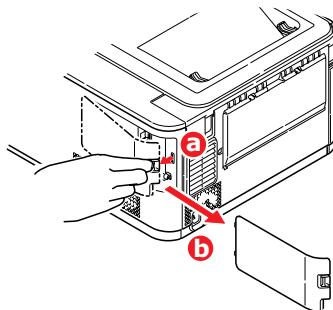
3. Gire el tornillo de bloqueo (a) en sentido contrario a las agujas del reloj y retire la cubierta de acceso interior (b). Colóquela con cuidado a un lado.
