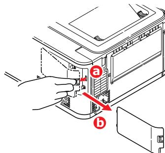
3. Tournez la vis de verrouillage (a) dans le sens inverse des aiguilles d'une montre et retirez le capot d'accès intérieur (b). Mettez-le de côté, dans un endroit sûr.
