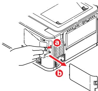
3. Gire o parafuso de retenção (a) no sentido anti-horário e remova a cobertura de acesso interna (b). Coloque-a de lado de modo seguro.
