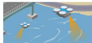
空飛ぶ水中測深(ドローン)
