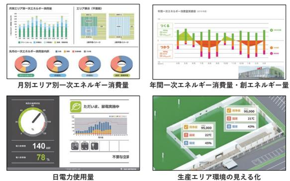
図3 エネルギーの見える化(大成建設資料より)
