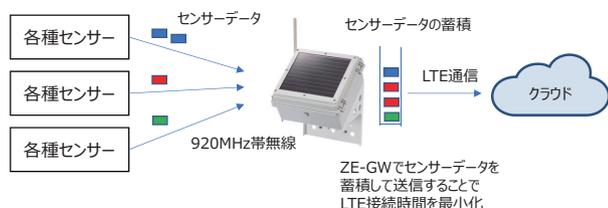
図8 LTE通信による省電力化<sup>6)</sup>
