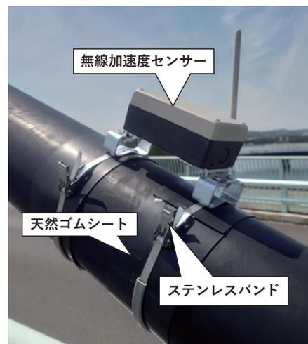
図3 無線加速度センサーの設置例
