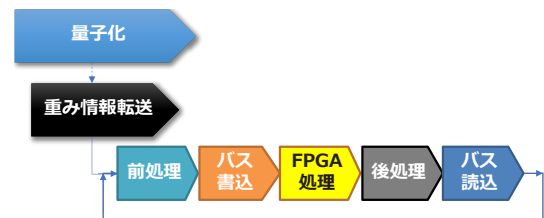
図1 FPGAを用いたAIアクセラレーションのフロー
