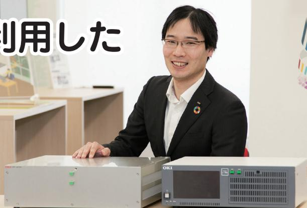
光ファイバーケーブルに外部から物理的な刺激が加わると、散乱光が変化します。この散乱光をセンシングに利用し、光通信技術を組み合わせ商品化されたのが光ファイバー温度・歪み(ひずみ)センサーです。そのOKI独自技術をブラッシュアップし、新たな視点で社会課題の解決に挑む技術者を紹介します。
