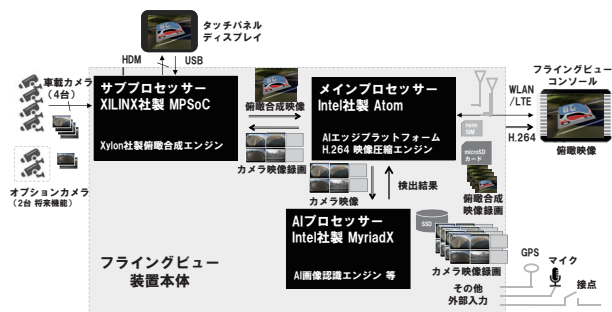
図6 フライングビュー装置本体の構成
