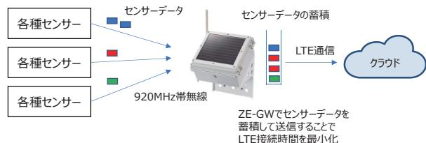
図5 LTE通信制御による省電力化
