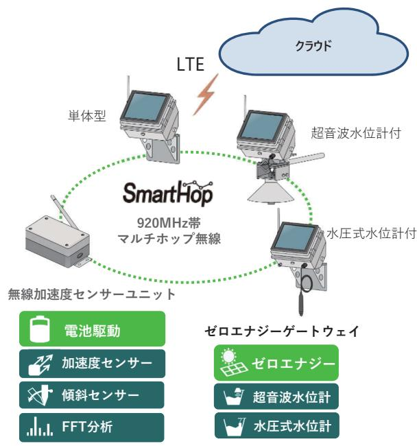
図2 ZE-GW のモニタリングシステム構成
