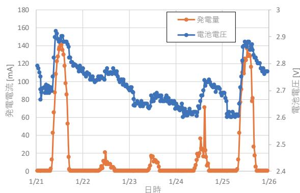
図4 充電電流と電池電圧の実証データ
