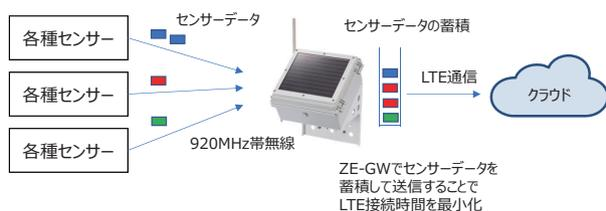
図5 LTE通信制御による省電力化
