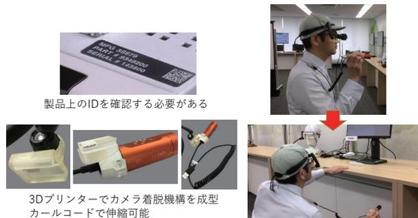
図4 カメラの着脱機構
