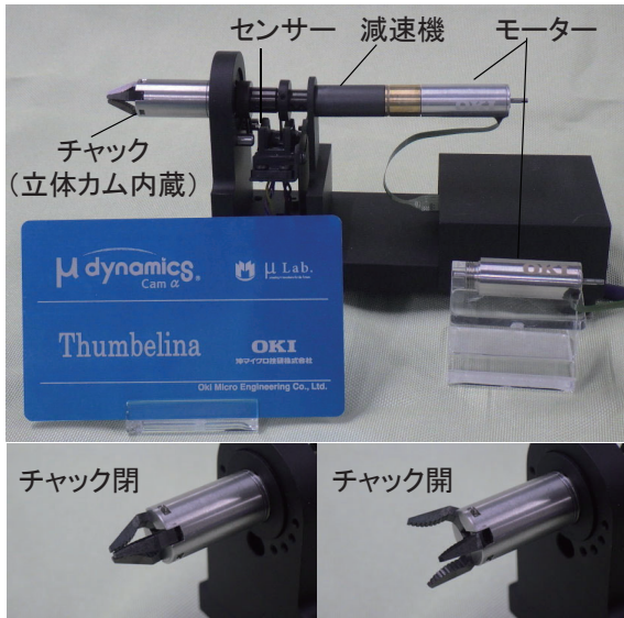
写真3 φ10 モーター搭載チャック
