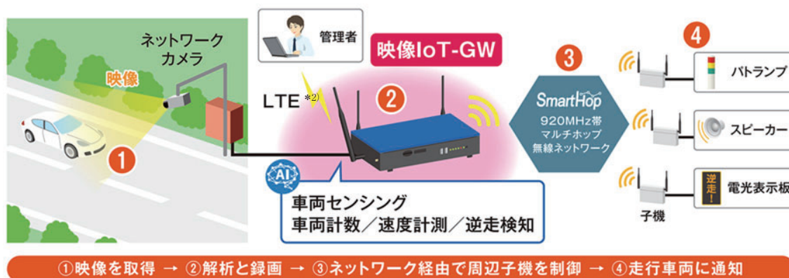
図2 「AISION 車両センシングシステム」と外部IoT機器連携による警告通知例
