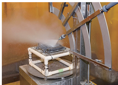
JAB認定を取得した耐水性試験の様子
