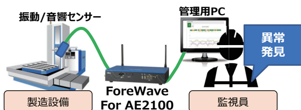
図3 個別製造設備の監視
