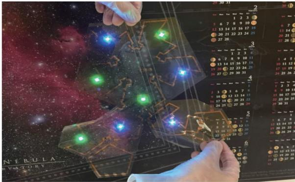
写真4 透明FPCにLED素子を実装した状態
