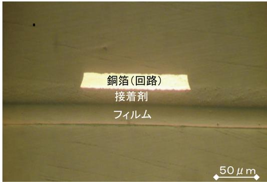
図1 フィルムに接着剤で銅箔を貼った FPC 断面
