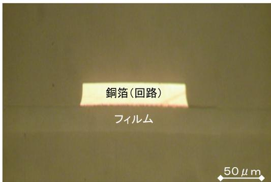
図2 フィルムに直接銅箔を形成した FPC 断面
