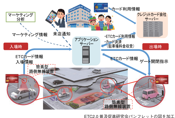
図2 ETC2.0を活用した駐車場決済サービス概念図
