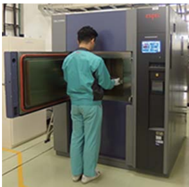
300℃対応熱衝撃試験設備
