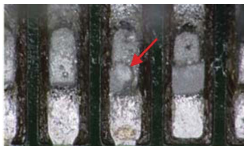
図7 はんだ接合部のボイド検出事例
