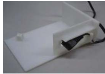
・機種：ルーター製品（後部の部分試作） ・検証項目：ケーブル固定部の形状検証
