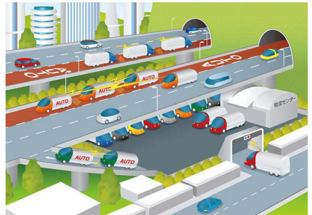
図1 専用レーンによる隊列走行のイメージ (エネルギーITS推進事業パンフレット 2) より)
