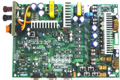
写真1 DCDCコンバータ電源
