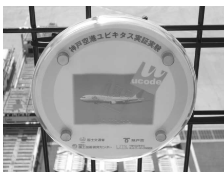
写真5 屋外設置型RFIDタグ
