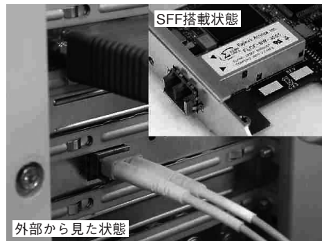
図4 SFF光トランシーバ使用例
