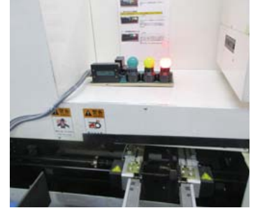
装置の稼働状況をランプの色でオペレーターに通知
