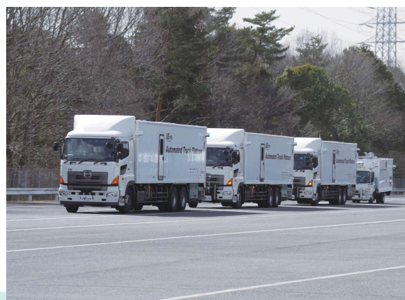
車車間通信を利用した大型車隊列走行
