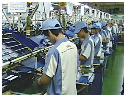
中国深圳にあるATM工場の紙幣カセット組立ライン
