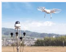
ドローン探知システムの音響センサー部
