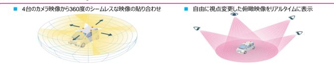
(\*1) 画像合成処理はProgrammable SoCを活用した高速データ転送技術による運転支援システムのデザインサービスなどで実績のあるOIDS(OKIアイディエス)で設計、実装し格段の低消費電力を実現
