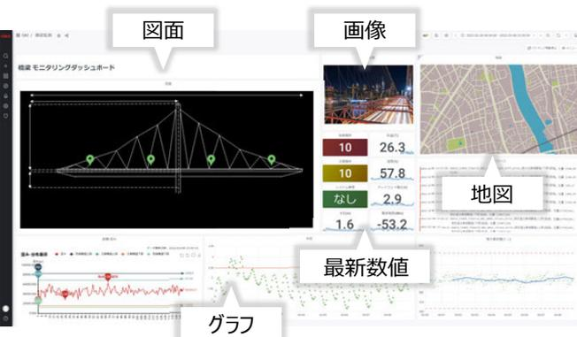
直感的に分かりやすい画面をニーズに合わせて合成し、センサーデータからインフラ構造物の状態診断を行い、異常時はメールで通知します。
