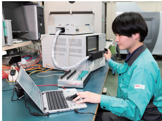
「劣化評価試験サービス」における電子部品の電気特性取得の様子
