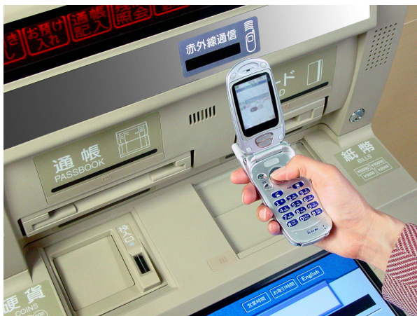
写真1 新しい入出力操作の登場 （赤外線通信による携帯電話との入出力の例）
