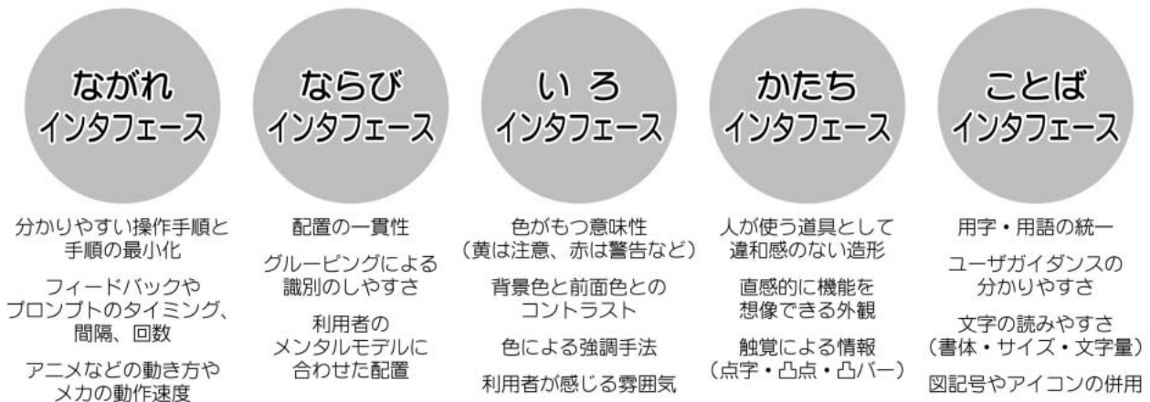
図1 顧客操作型端末におけるインタフェースの5つの側面
