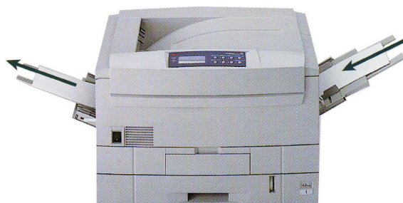
写真1 媒体搬送ストレートパス
