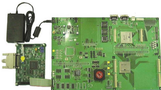
写真2 μ PLATcore-7Cプロトタイプボード Photo 2 Prototyping board of μ PLATcore-7C
