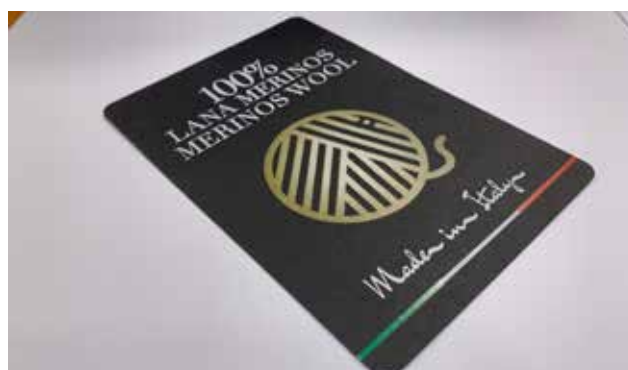
Tag abbigliamento finito per il quale sono stati utilizzati i cinque toner (CMYK + Bianco) per il testo bianco su supporto di stampa scuro
