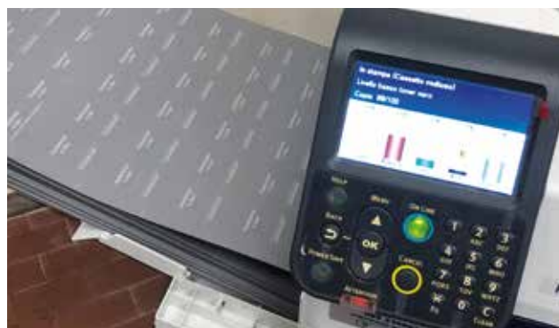
Panel de visualización de la Pro9542 de OKI que muestra el estado del tóner de cinco colores (CMYK + blanco)
