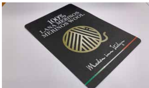
Una etiqueta para ropa terminada, en la que se utilizan los cinco tóneres (CMYK + blanco) para que el texto blanco destaque sobre el soporte oscuro
