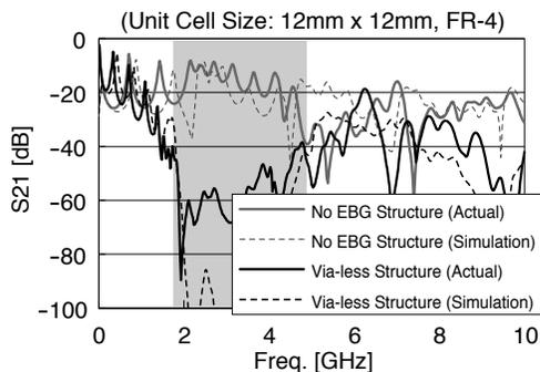
(d) Example Transmission Properties of Via-less EBG Structure
