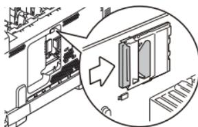
7. Localice los clips de sujeción en la parte inferior de la cubierta lateral e introduzcalos en los orificios rectangulares situados cerca de la parte inferior de la impresora.
