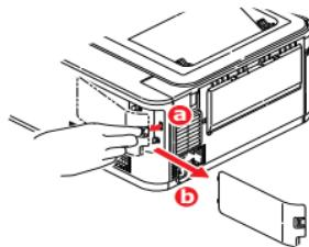
3. Tournez la vis de verrouillage (a) dans le sens inverse des aiguilles d'une montre et retirez le capot d'accès intérieur (b). Mettez-le de côté, dans un endroit sûr.
