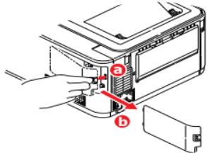
3. Gire o parafuso de retenção (a) no sentido anti-horário e remova a cobertura de acesso interna (b). Coloque-a de lado de modo seguro.
