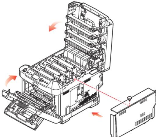
9. Cierre la cubierta frontal y después la cubierta superior, presionando firmemente hacia abajo en ambos lados para cerrarla bien.
