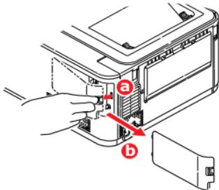
3. Gire el tornillo de bloqueo (a) en sentido contrario a las agujas del reloj y retire la cubierta de acceso interior (b). Colóquela con cuidado a un lado.
