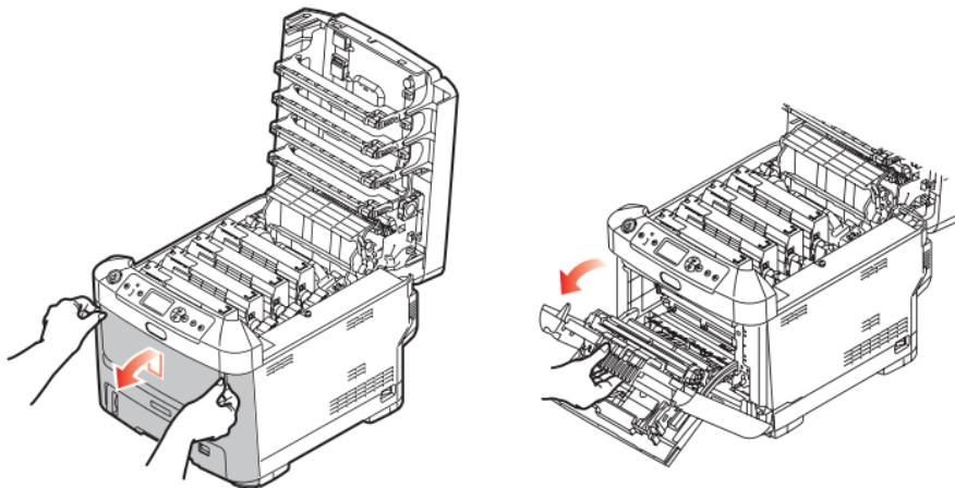
4. Afloje el tornillo (a) que sujetla la cubierta en el lado derecho. Levante ligeramente el borde de la cubierta lateral y sepárela de la impresora por la parte superior.
