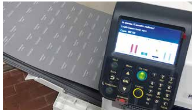
Bedienfeld des Pro9542 von OKI mit Statusanzeige für die fünf Farbtöne (CMYK + Weiß)
