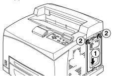
2. Allineare e inserire le sporgenze nella parte superiore del coperchio estraibile destro nelle scanalature della stampante (1). Inserire le sporgenze della parte inferiore del coperchio nella stampante (2) e fare scorrere lo stesso coperchio verso la parte anteriore della stessa (3).
