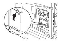
4. Inserire con delicatezza nell'alloggiamento il kit software di rete; premere con decisione l'angolo superiore, quindi l'angolo inferiore della scheda.
