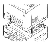
**9.** Inserire i fermi forniti nelle due posizioni interne e nelle due posizioni sul retro della stampante. Fissare bene i fermi.
