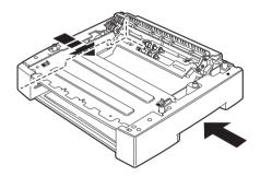
4. Allineare gli angoli anteriori e posteriori dei moduli cassetto superiore e inferiore, quindi abbassare lentamente il modulo superiore in modo che i perni della guida entrino nei fori della piastra di base dello stesso.
