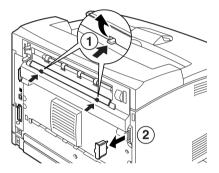
2. Inserire le linguette destra e sinistra della parte inferiore dell'unità duplex nei fori sul retro della stampante, quindi allineare la parte superiore dell'unità duplex alla stampante. Assicurarsi che il connettore dell'unità duplex sia collegato al connettore della stampante.
