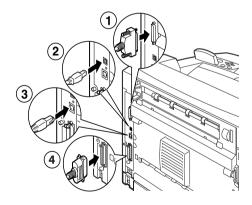
2. Per i cavi parallelo, USB o seriale, collegare l'altra estremità del cavo al connettore di interfaccia del computer.
