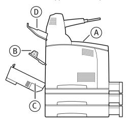
**Coperchio A:** quando il cassetto di raccolta sfalsata opzionale è installato, piegare il cassetto prima di aprire il coperchio A. Quando viene visualizzato un messaggio che indica di rimuovere il tamburo/cartuccia di toner, vedere "Interno del coperchio A" a pagina 55.
