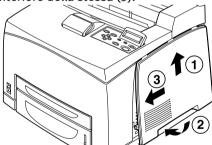
3. Fissare la vite sul coperchio estraibile destro.
