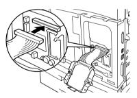
5. Tenere il disco rigido come mostrato nell'illustrazione e installarlo nella stampante. Allineare la freccia sul disco rigido con la freccia sulla stampante e inserire la staffa presente sulla parte superiore del disco nella posizione di installazione.
