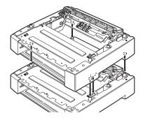
5. Inserire i fermi forniti nelle due posizioni interne al modulo cassetto e nelle due posizioni sul retro del modulo cassetto. Fissare bene i fermi.
