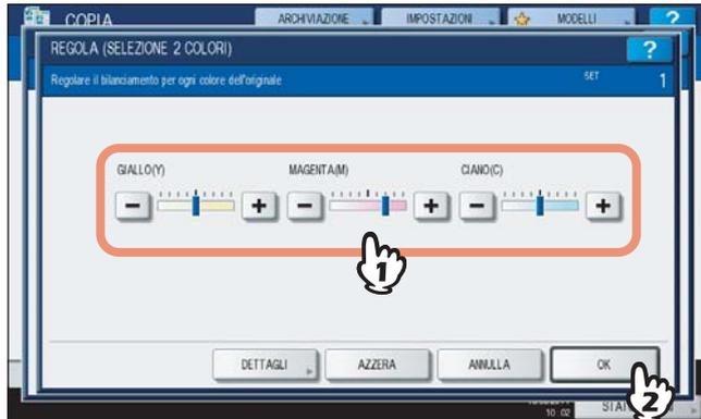
Completata la regolazione, premere [OK]. Con questa operazione si conclude la procedura. Per regolare il bilanciamento colore su ogni area di densità, premere [DETTAGLI] e passare al punto successivo.
