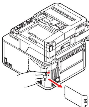
3. Girare le viti di blocco (a) in senso antiorario e rimuovere il coperchio di accesso interno (b). Posizionarlo su un lato in un luogo sicuro.
