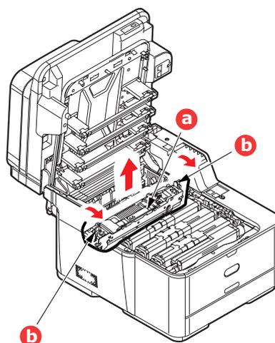
4. Tirare le due levette di fissaggio (b) del fusore verso la parte anteriore della stampante in modo da trovarsi in posizione verticale.
