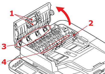
4. Ruotare i rulli in avanti con le dita e ripetere il passaggio 3 finché i rulli non sono puliti.
