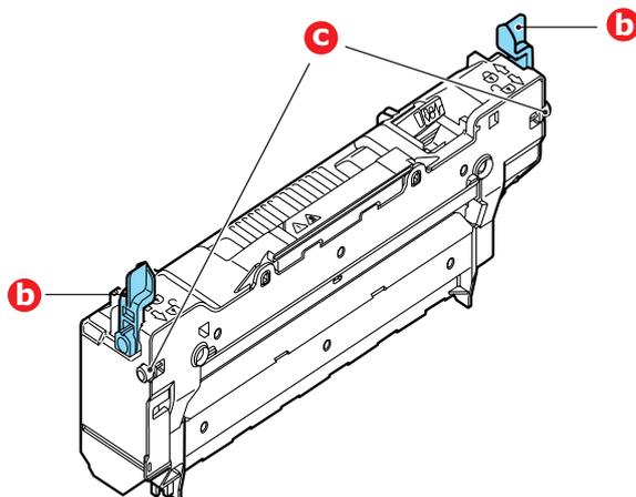
8. Inserire il fusore nella stampante, collocando le due alette (c) negli appositi alloggiamenti ai lati della cavità della stampante.
