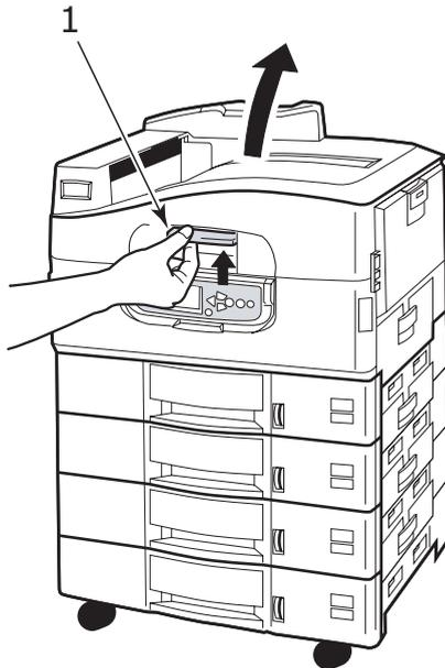
Schließen Sie die obere Abdeckung, indem Sie sie behutsam bis zum Anschlag auf halbem Weg andrücken (1). Drücken Sie die Abdeckung dann fester an, um sie vollständig zu schließen. Achten Sie darauf, dass die Abdeckung fest verschlossen ist.
