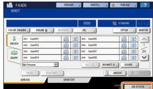
2 1 Drücken Sie [FAX], 2 wählen Sie zeitversetzte Sendung die Sie löschen wollen und 3 drücken Sie [LÖSCHEN].
