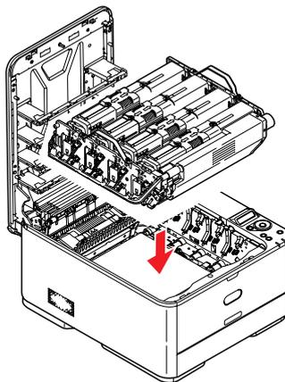
14. Schließen Sie zuletzt die obere Abdeckung, indem Sie fest auf beide Seiten drücken, sodass sie einrastet.
