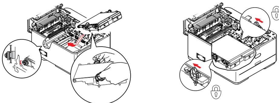
7. Drücken Sie die Riegel zur Rückseite des Geräts. Dadurch wird die Transportbandeinheit gehalten.
