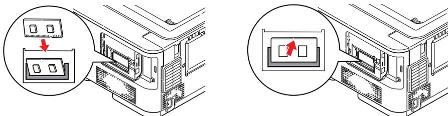
10. Setzen Sie die innere Zugriffsabdeckung (b) wieder ein, und drehen Sie die Feststellschraube (a) im Uhrzeigersinn, um sie anzuziehen.
