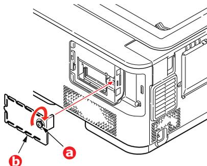
7. Setzen Sie die Zugriffsabdeckung wieder ein, und lassen Sie sie einrasten.
