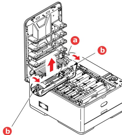
3. Ziehen Sie die beiden Verriegelungshebel (b) zur Drucker-Vorderseite, so dass sie ganz aufrecht stehen.
