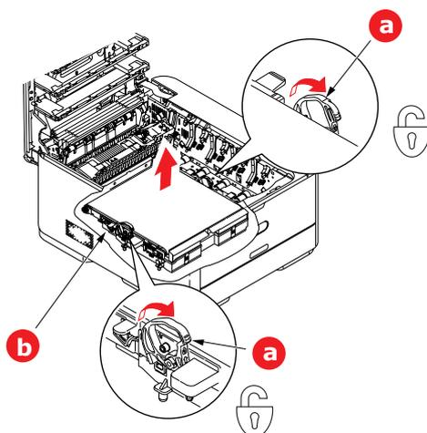
5. Heben Sie das Transportband (b) mithilfe der Riegel (a) an, und nehmen Sie es aus dem Gerät heraus.
