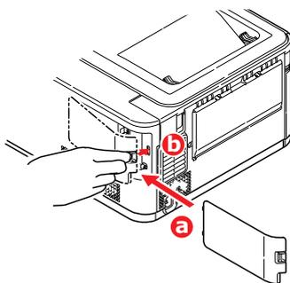
8. Schließen Sie den Netzstecker wieder an, und schalten Sie den Drucker ein.
