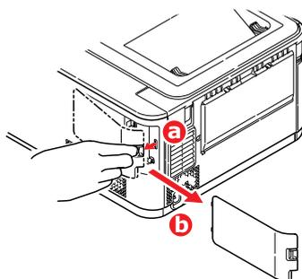
3. Drehen Sie die Feststellschraube (a) gegen den Uhrzeigersinn, und entfernen Sie die innere Zugriffsabdeckung (b). Legen Sie sie sicher auf einer Seite ab.
