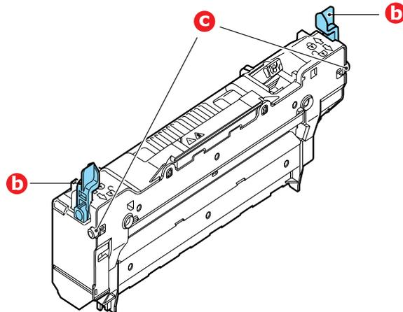
7. Setzen Sie den Fixierer so in den Drucker, dass die beiden Zapfen (c) in die Schlitzte in den Seiten des Druckerinnenraums eingeführt werden.
