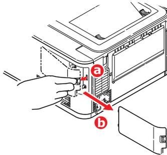
3. Drehen Sie die Feststellschraube (a) gegen den Uhrzeigersinn, und entfernen Sie die innere Zugriffsabdeckung (b). Legen Sie sie sicher auf einer Seite ab.
