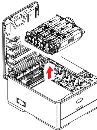
3. Stellen Sie die Einheit an einen sicheren Ort, an dem Sie keinen direkten Wärme- und Lichtquellen ausgesetzt ist.
