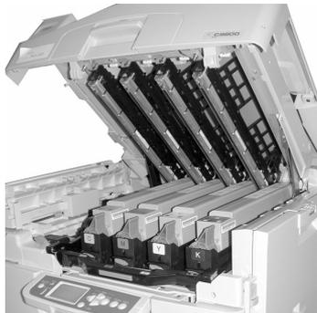
3. Utilisez le chiffon fourni avec les cartouches de toner (ou un chiffon propre et doux) pour essuyer délicatement la tête d'impression à DEL (1).
